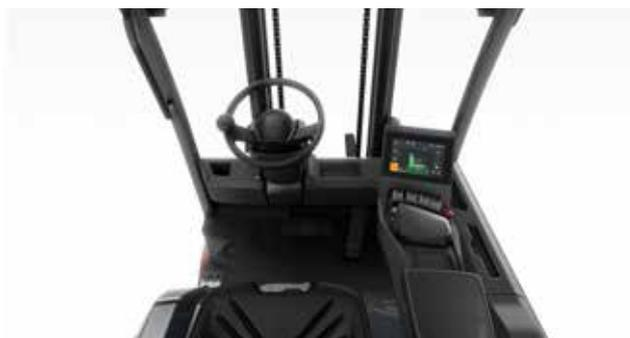
Vano di guida progettato all'insegna dell'ergonomia dotato di un nuovo bracciolo e appoggio per il palmo della mano, con una scelta di comandi idraulici per offrire all'operatore totale comfort durante l'intero turno.
