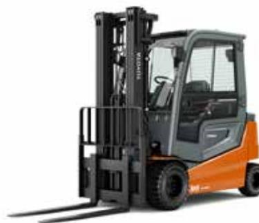
Il vano di guida completamente flottante isola dalle vibrazioni e dal rumore migliorando il comfort e la produttività.
